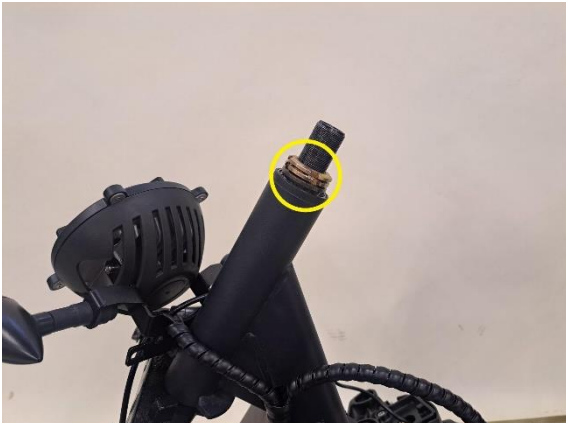
Irrota ohjaustangon laakerien lukkomutterit (siirtoleukapihdit).
