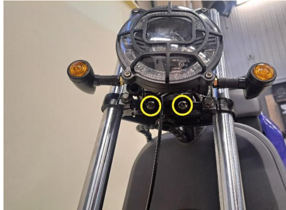
Irrota etuvalon kiinnikkeen kiinnityspultit (kuusiokoloavain 5 mm).
