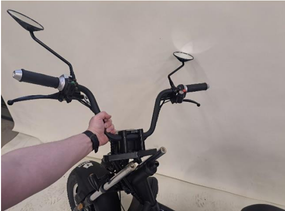
Nosta etuhaarukan yläosa ohjaustankoineen sivuun.
