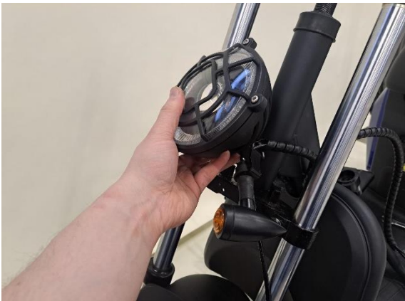
Siirrä etuvalo kiinnikkeineen sivuun.
