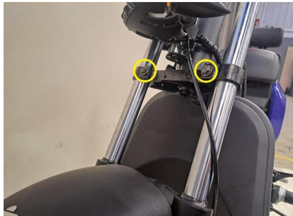
Löysää etujousien kiinnityspultteja (kiintoavain 12 mm).
